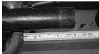
Figure 9 – Vérification de la refuite nécessaire pour un tuyau monté sur système d'entraînement 300 Power Drive
