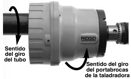
Figura 11 – Método apropiado para, con una preparadora, quitarle el revestimiento exterior a un tubo que está girando
