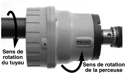
Figure 11 – Utilisation de l'outil de préparation pour le décapage d'un tuyau en rotation
