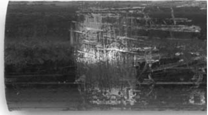
Figura 14A – Rayones en la zona de preparación hechos por las mordazas de una llave inglesa
