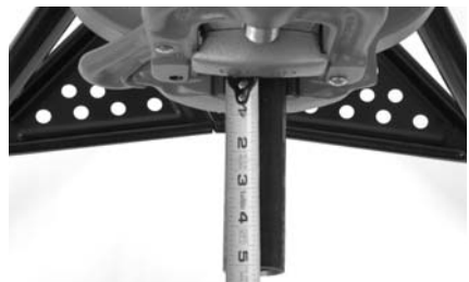
Figure 6 – Vérification de refuite avec le tuyau dans un étau
