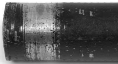
Figure 14B – Traces de mandrinage du système d'entraînement 300 PD sur la zone de traitement
