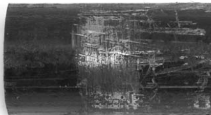
Figure 14A – Traces de clé à tubes sur la zone de traitement
