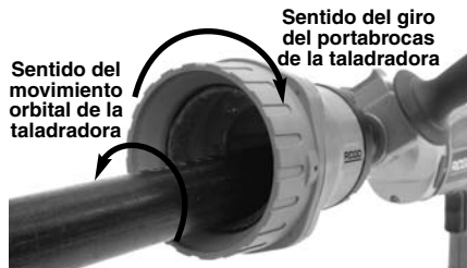
Figura 8 – Limpieza externa del extremo de un tubo inmóvil
