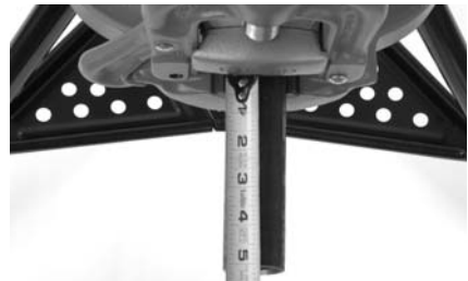
Figura 6 – Tubo sujeto por una prensa de tornillo y medición de la distancia mínima necesaria para efectuar la preparación del tubo
