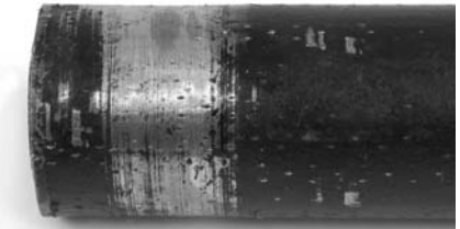
Figura 14B – Marcas dejadas por el portabrazos del Accionamiento Motorizado 300 en la zona preparada
